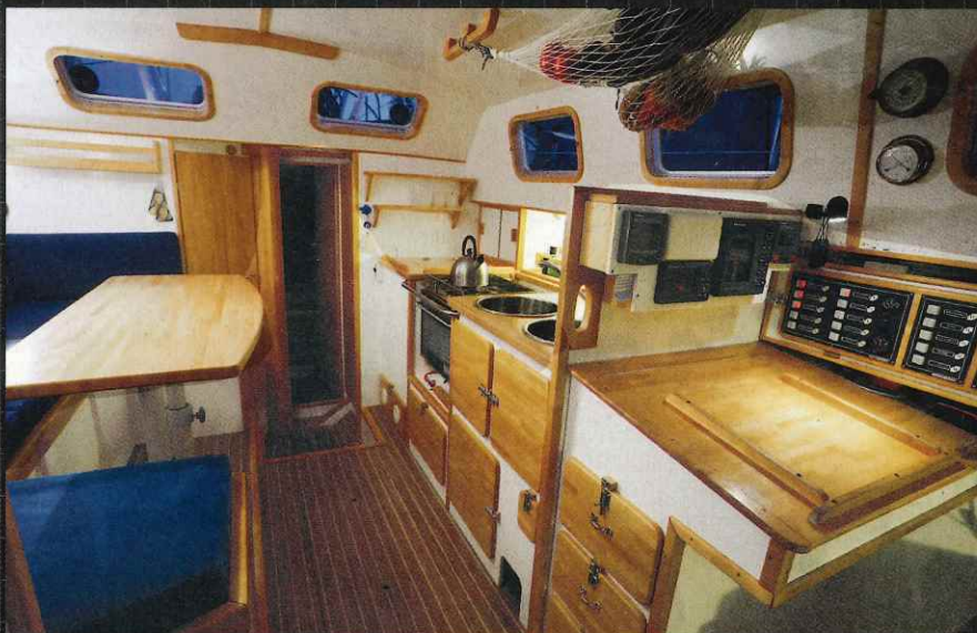
▲ La cuisine richement équipée et généreuse en rangements est séparée de la table à cartes par une demi-cloison qui sert surtout à monter l'électronique. Les boiseries en hêtre ont très bien vieilli.
