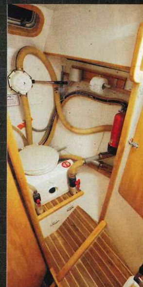
▲ Le WC à dépression Lavac occupe un espace étriqué.
