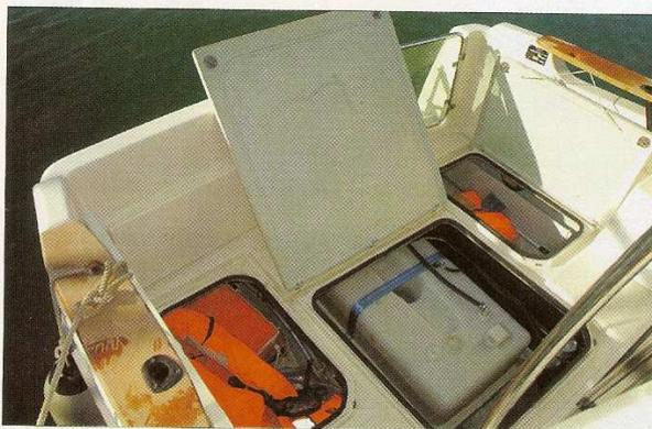
La capacité de stockage est importante dans les soutes placées sous le cockpit. Leur capot est maintenu ouvert par un élastique.
